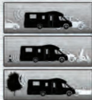
Maksimal sikt bakover for ekstra sikkerhet under manøvrering: ryggekamera, 4 parkering sensorer bygget inn i støtfangeren, to parkeringssensorer i den øvre delen for hindringer utenfor rekkevidden til ryggekamera.
